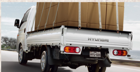
Capacidad sobre eje posterior: 1,920 kg Aros: 13" en posterior y 15" en delantero
